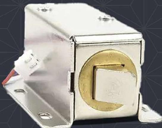
◆ قفل برقی 12 ولت کمدی که برای درب های کمدی استفاده می شود و با قرار دادن یک شاسی در سرراه آن میتوان با اتصال برق زبانه رابه عقب حرکت داده و درب را باز کند
